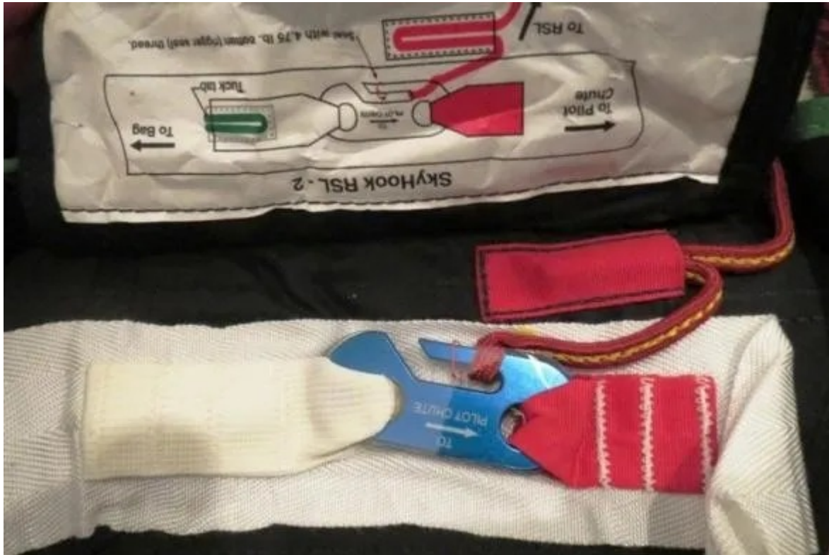
Figur 9: Skyhook montert på pilotbåndet
