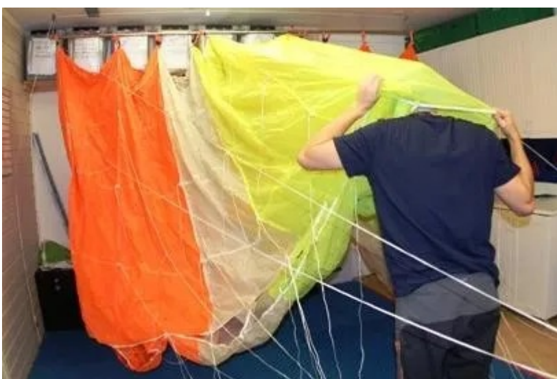
Figur 3: Inspeksjon av ribber og crossports
