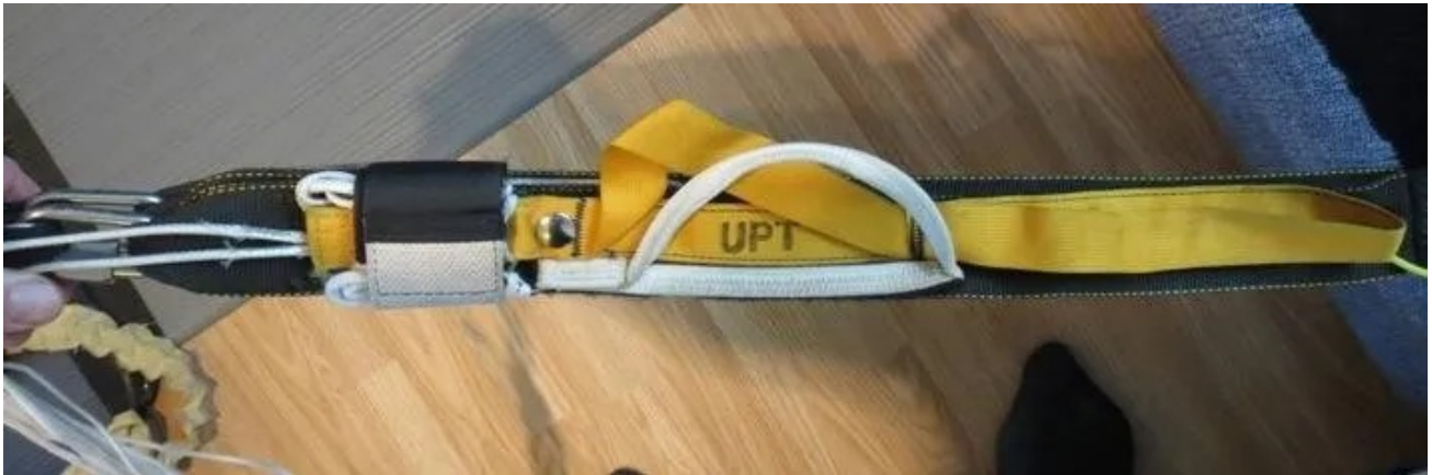
Figur 1: Kontroll av styrehåndtak med låseløkker og trykk-knapper
