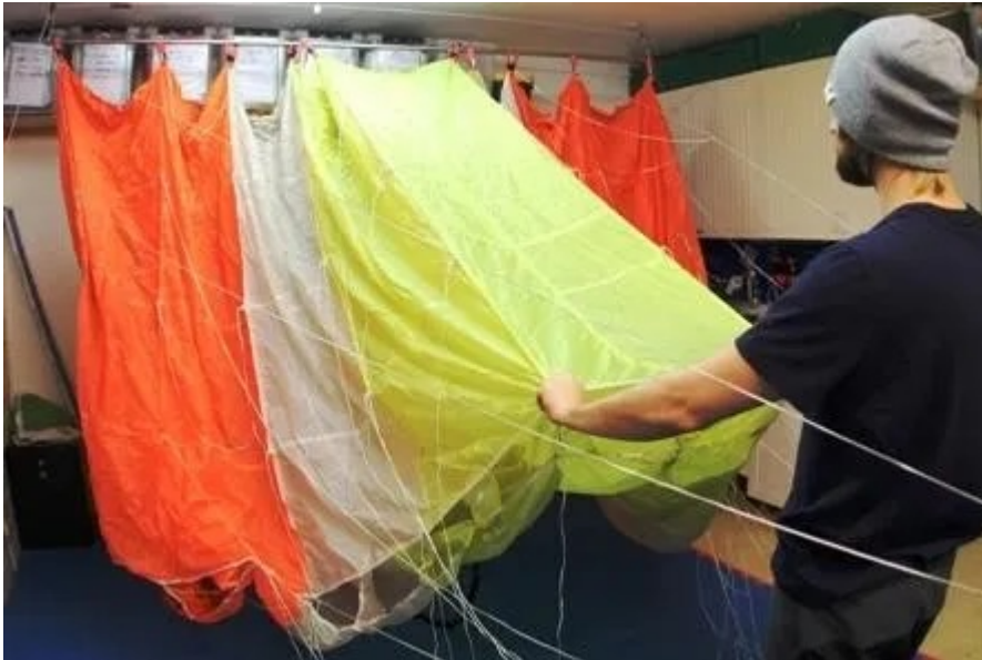
Figur 2: Inspeksjon av bunnduk
